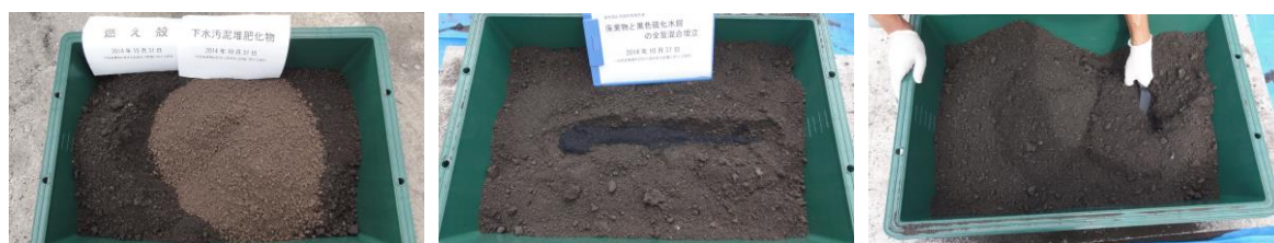
廃棄物の混合（燃え殻：堆肥＝8：2） 廃棄物に黒色硫化水銀を添加廃棄物と黒色硫化水銀の完全混合
