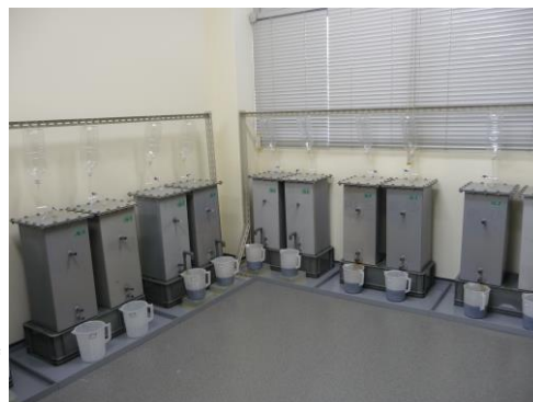
図3.2.3 水銀廃棄物の埋立槽図および埋立実験槽の設置状況
