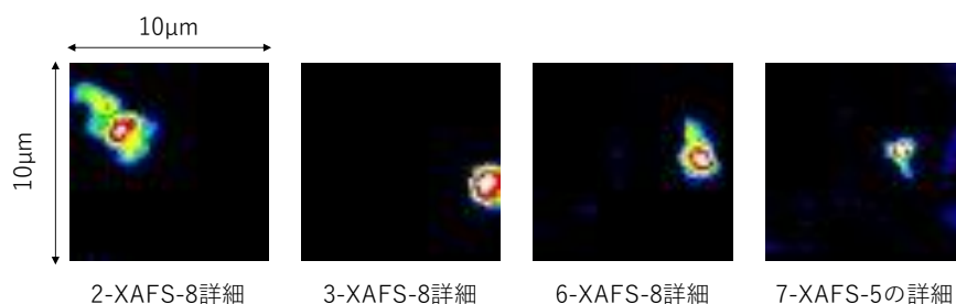
図4.2.13 槽中央部に水銀廃棄物を充填した埋立実験槽の最下層部の水銀粒子の検出
