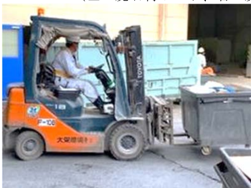
写真(4)-23 コンテナの運搬 (コンテナ下部は キャスターとフォークリフト用の穴 がある)
