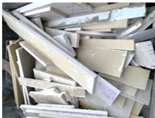
写真(4)-22 コンテナ内の廃石膏ボード
