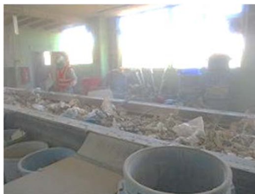
写真(4)-4 粗選別後の手選別ライン選別コンベアーの状況（6人体制）
