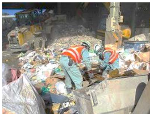
写真(4)-2 処理ヤードにおける目視での粗選別の状況
