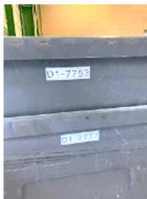
写真(4)-24 コンテナ管理用の IC タグ (コン テナ毎に管理し、異物や水濡れのあ るものは返却)
