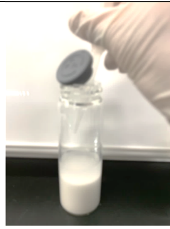
⑩ N_2 ガスで2分間気相を置換 気流は表面が波立つ程度の強さ
