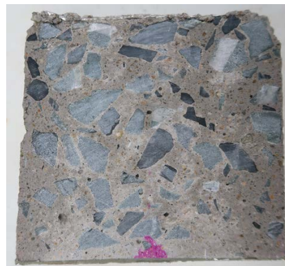
(d) 60°C加温硬化型試験後(49.0mm)
