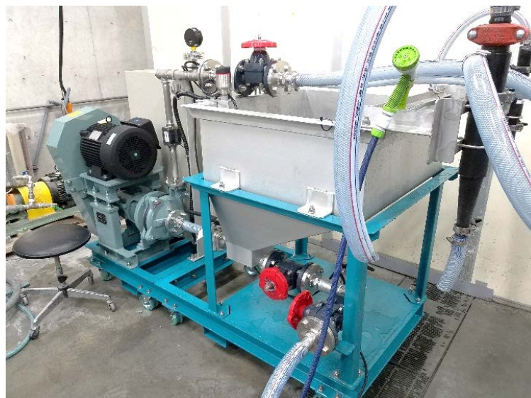
写真 3.3.1 ハイドロサイクロン脱水濃縮設備外観
