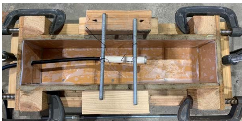
写真3.3.2 自己収縮試験供試体用の型枠と埋込みゲージ
