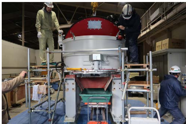
写真4.4.1 実験に用いた実規模のミキサ
