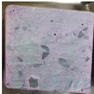
(b) 60°C加温硬化型試験前(0mm)
