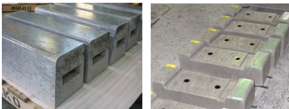
写真1.3.1 JIS品フライアッシュを使用したジオポリマー製品例
