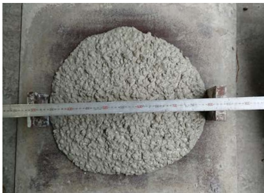
写真3.4.5 スランプフロー試験状況(500L)
