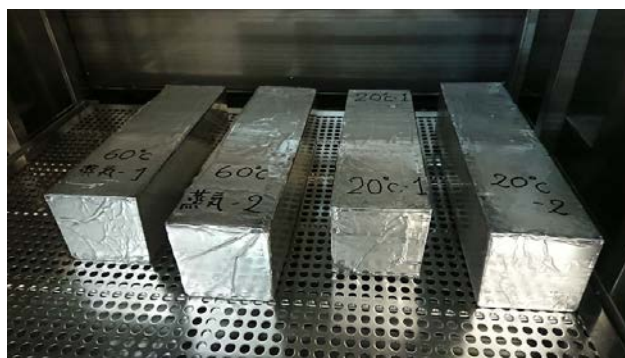
写真3.3.4 中性化試験状況
