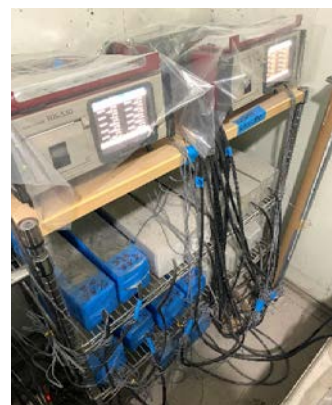
写真3.3.3 自己収縮試験状況
