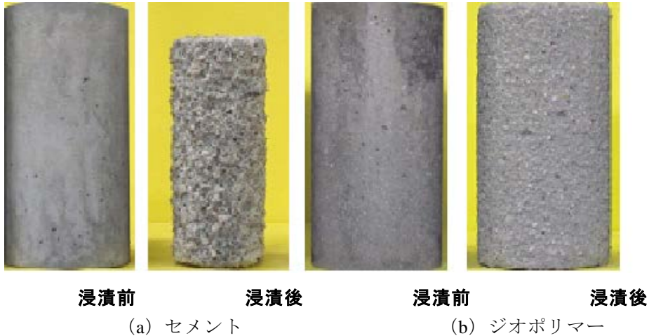
写真 4.4.1 硫酸浸漬前後の外観の比較 (浸漬材齢 8 週)
