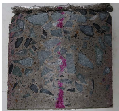
(c) 20°C常温硬化型試験後(41.3mm)
