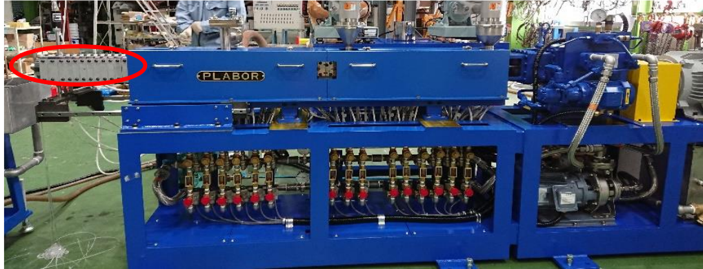
Fig. 16 福岡大学で試作した可変長樹脂溜まり付き二軸押出機
