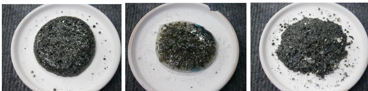
図4.3.4 試料A(左)、試料C(中)、試料D(右)の熔融試験後試料の外観
