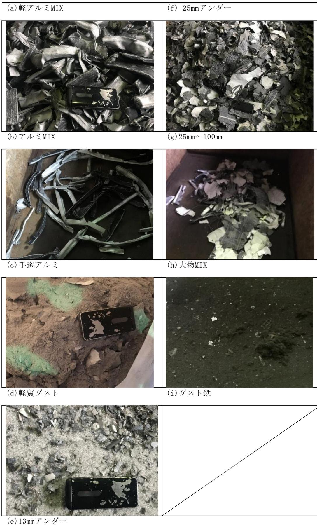
図4.1.3 PVパネルシュレッダー各種破碎産物の外観（平成30年3月9日破碎実施）
