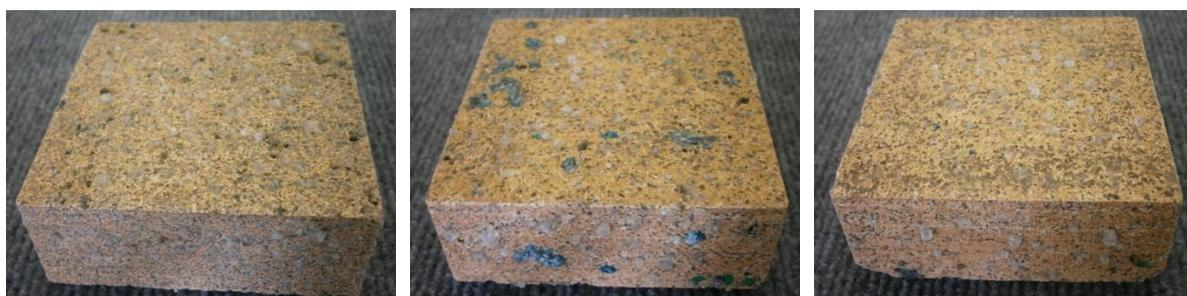
図4.3.6 焼成された試料A(左)、試料C(中)、試料C'(右)のセラミックブロック
