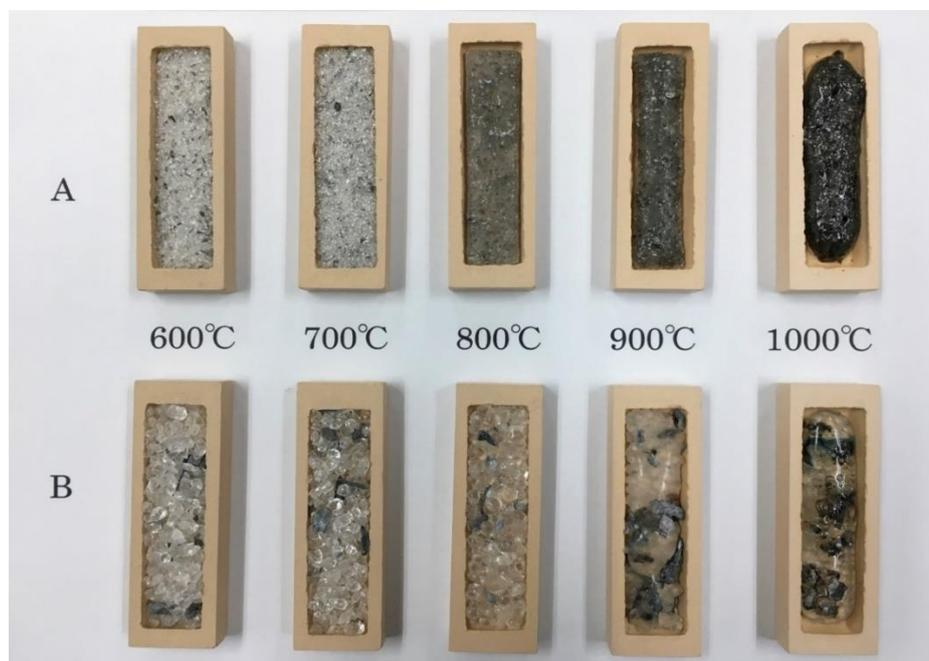
図4.3.1 試料A（上）とB（下）の各温度での熔融後の試料外観（いずれも長径：80 mm）
