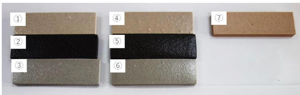
図4.6.2 製造されたセラミックスタイルの外観（いずれも長径：80 mm）
