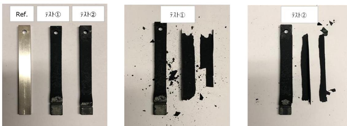
図4.3.12 腐食試験前（左）後（中央・右）の試料外観
