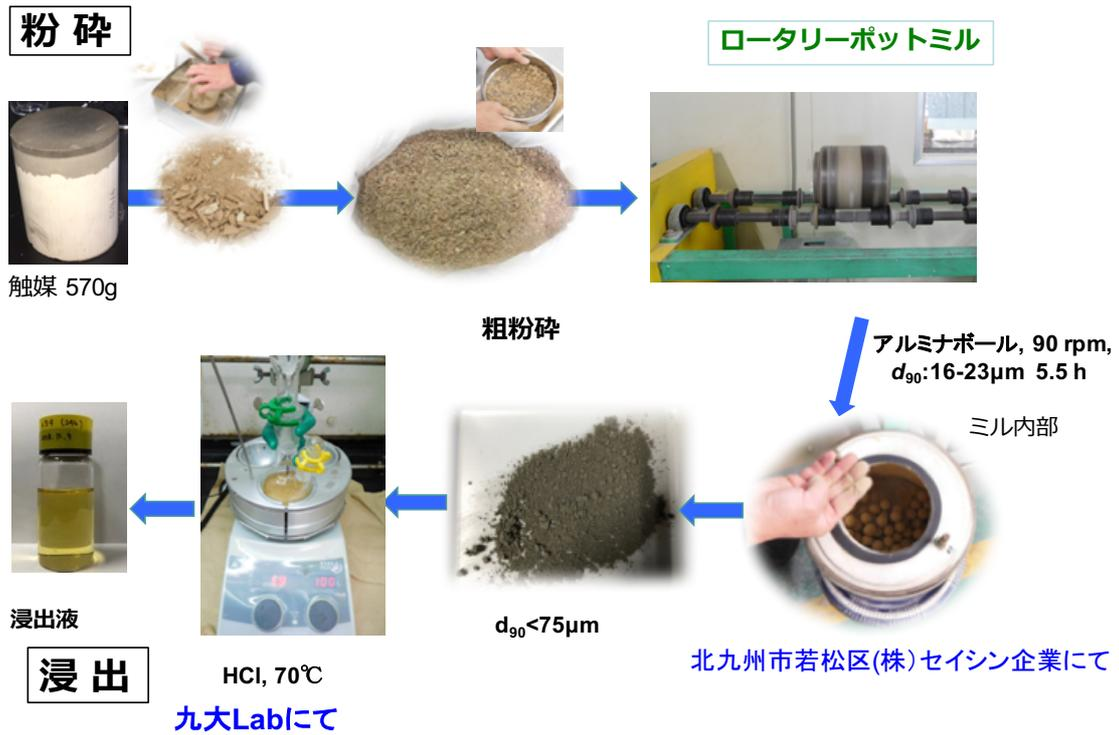
図3.3 触媒の粉碎と浸出
