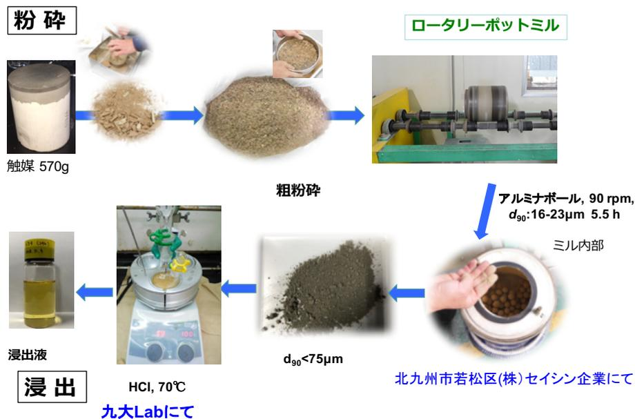
図3.3 自動車触媒の粉砕と浸出
