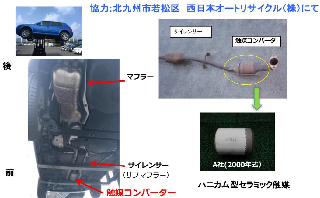
図3.2 自動車排ガス触媒の調達（解体、選別）
