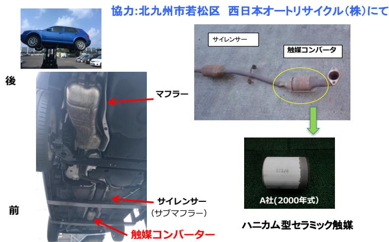
図3.2 自動車排ガス触媒の調達（解体、選別）
