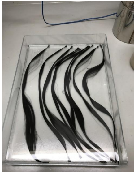
図 5 切断後に THF に浸した炭素繊維 (T800)
