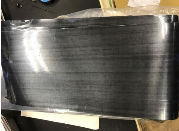
東レ、トレカプレプリグ T800 (P2255S-15)、 プリプレグ (T300)、F6343B-05P 図 6 実験に使用した炭素繊維強化プラスチック
