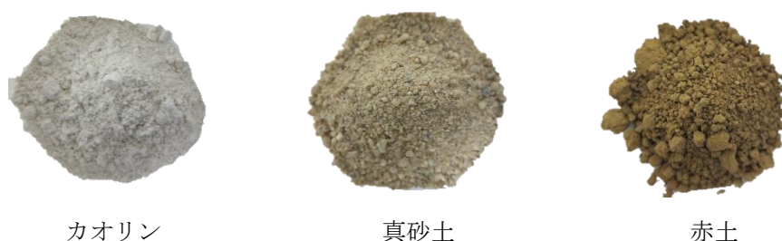
図3.1 吸着試験に用いた固相
