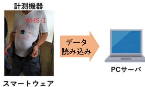
図4.4 計測システム（WHS-1使用時）
