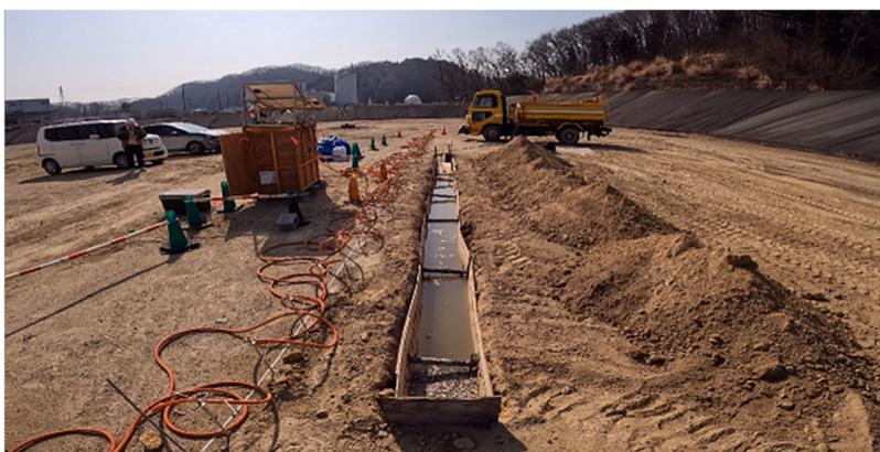
図1-3 水みちを把握するための注水試験と高密度電気探査
