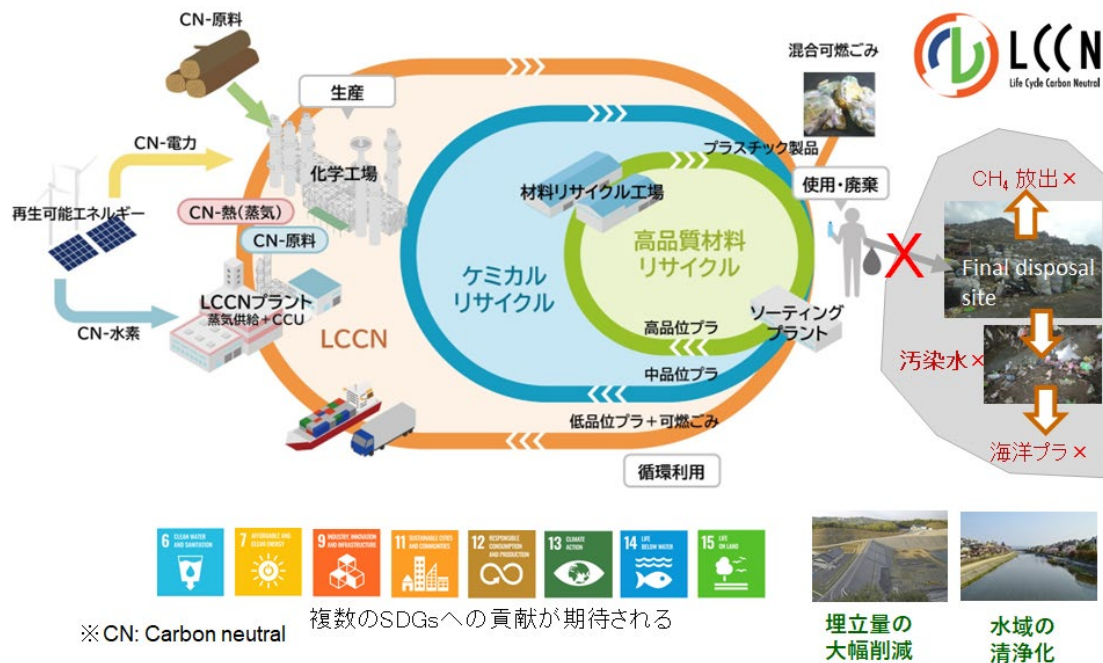
図2 LCCN（ライフサイクルカーボンニュートラル）の概念図
