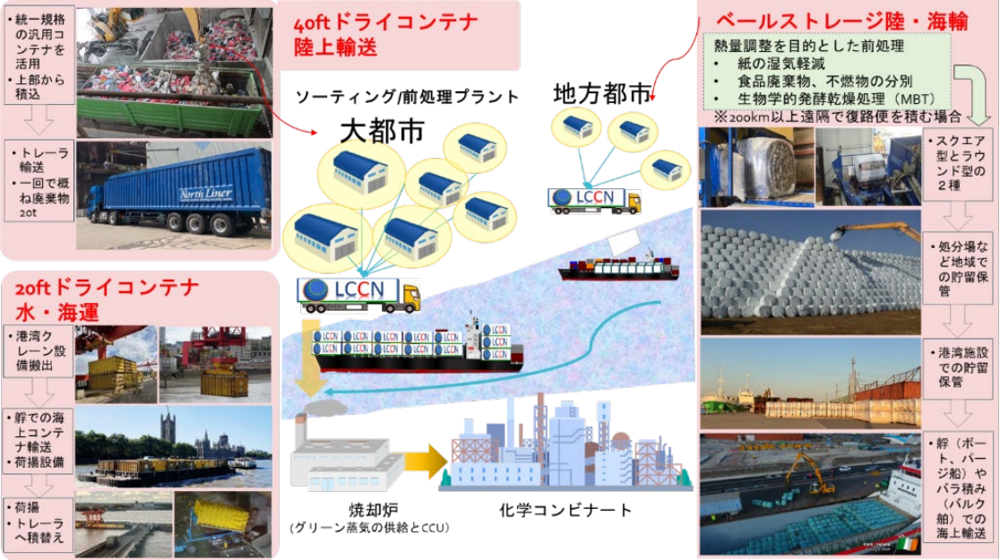
図 16 日本に適用しうる一般廃棄物の広域輸送適用技術
