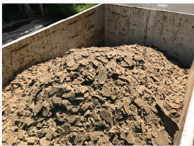
図1.4 石灰系凝集剤使用の 脱水汚泥
