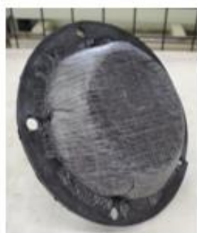
図-4.15 試験用金型を用いたハイブリッド成形試作品（UD材積層0°-90°+ReCFペレット）
