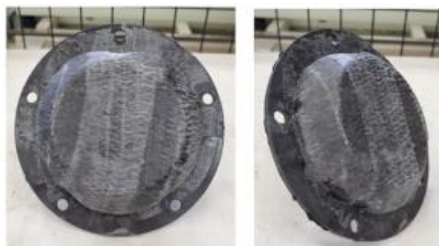
図-4.16 試験用金型を用いたハイブリッド成形試作品（織物+ReCFペレット）
