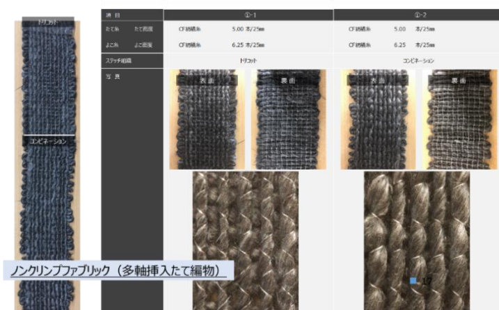
図-2.14 ReCF/樹脂混紡糸のたて編物技術への適用
