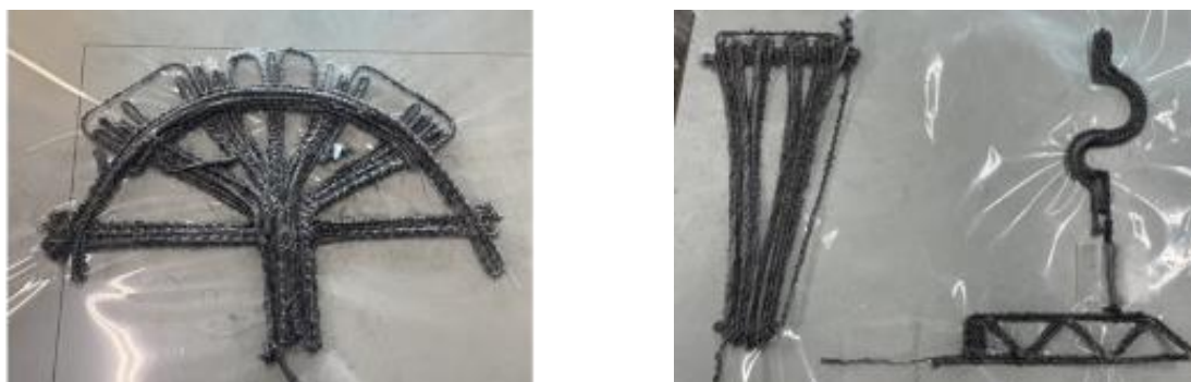
図-2.13 ReCF/樹脂混紡糸のTFP技術への適用
