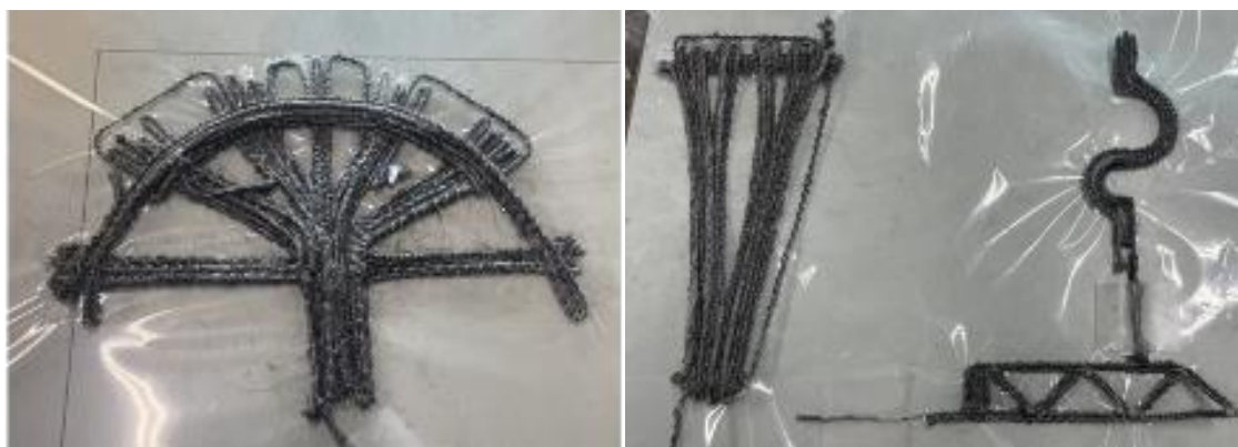
図-2.13 ReCF/樹脂混紡糸のTFP技術への適用
