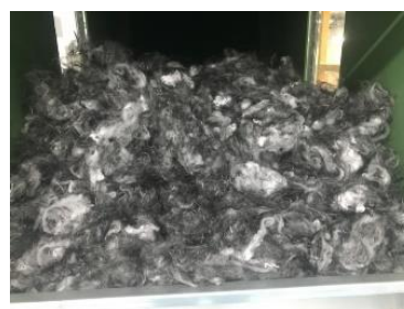
図-1.9 繊維開繊送綿装置設置後の混綿結果
