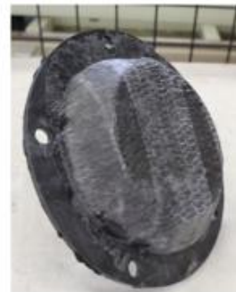
図-4.16 試験用金型を用いたハイブリッド成形試作品（織物+ReCFペレット）
