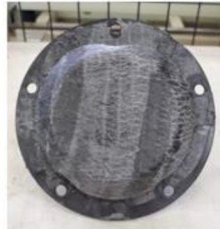
図-4.16 試験用金型を用いたハイブリッド成形試作品（織物+ReCFペレット）
