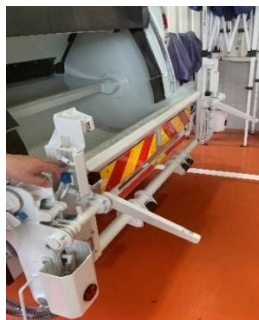
(c) 反転装置用のレバーおよび動作時の様子
