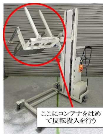
図 4 非接触型ごみ自動投入システム（小型コンテナ：78L）
