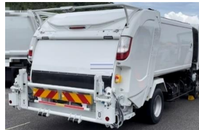
(b) パッカー車に取り付けられた大型反転装置
