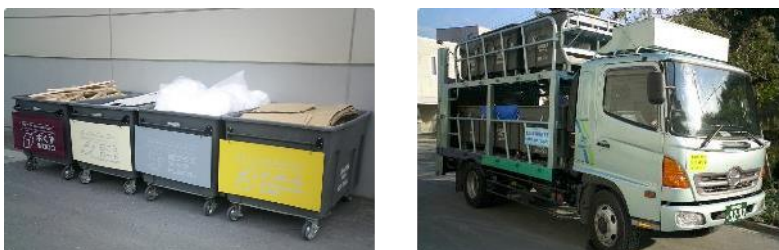
図 34 統一コンテナとそれを積載できる車両
