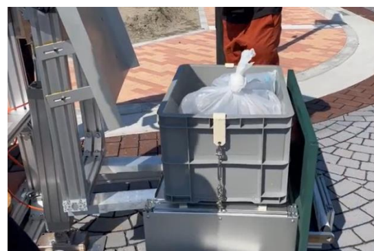
(b) ごみコンテナと小型反転装置の接続
