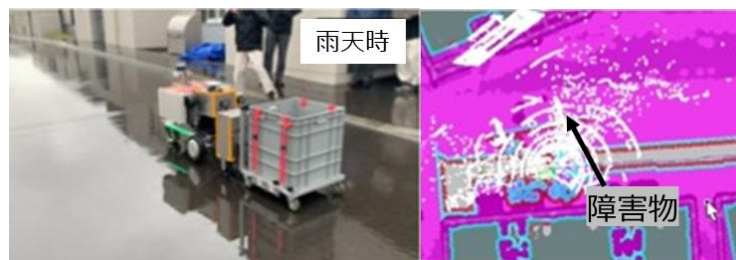
図 11 雨天時における自律走行型ロボットの様子
