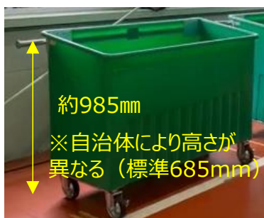
図 25 大型ごみコンテナのバー高さの違い
