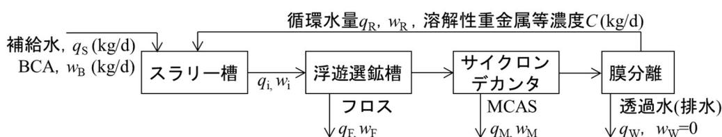
図2-13 連続式木質バイオマス燃焼灰改質システムにおける各プロセスの水量固形物量定義
