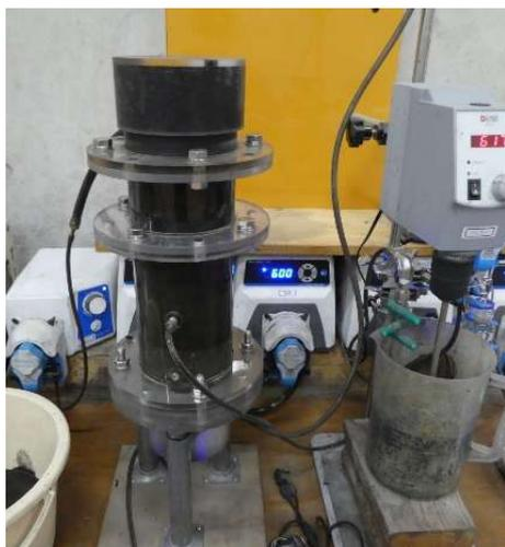
写真2-1 連続式プロトタイプ装置（小型2.3L）
