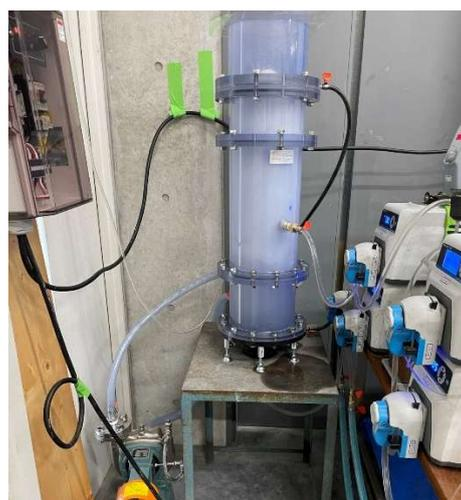
写真2-2 連続式プロトタイプ装置（中型18L）
