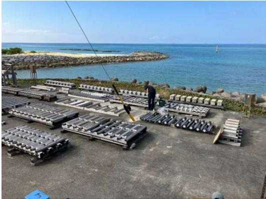
写真3-3 沖縄での曝露試験の状況
