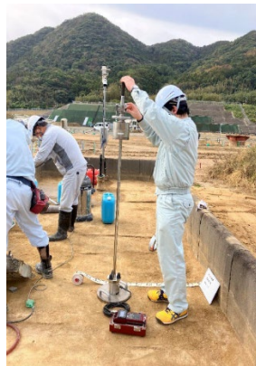
図-0.21 小型FWD試験機のご概念図 図-0.22 小型FWD試験の実施状況 図-0.23 小型FWD試験の結果
