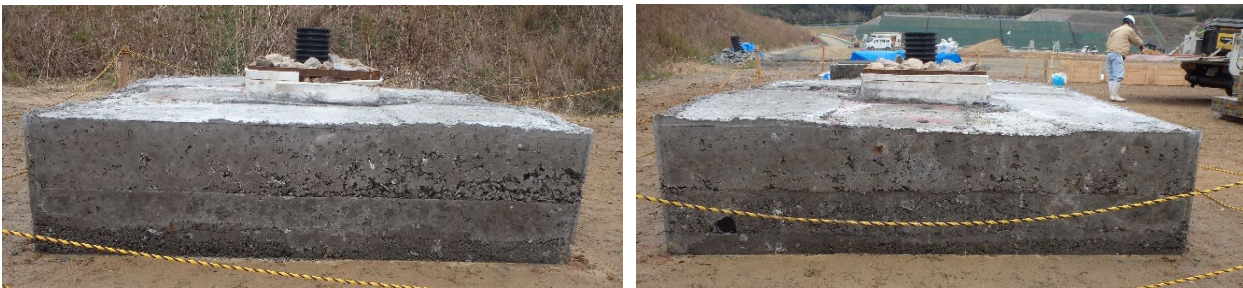
図-4.2.11 縦型ガス抜き管周辺模型の出来形
