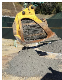
図-4.2.5 磁力選別状況 図-4.2.6 ふるい選別状況
