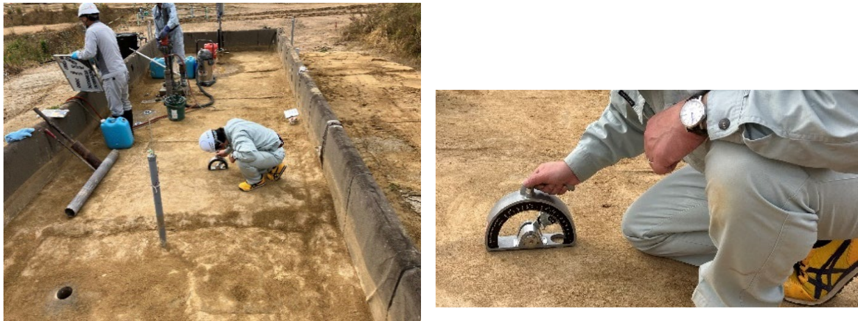
図-4.5.13 低強度シュミットハンマーの測定状況
