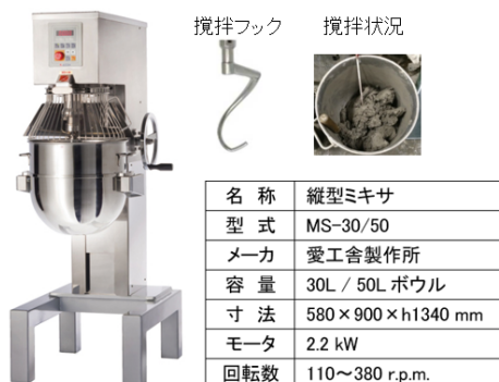
図-3.2.1 室内用縦型ミキサの概要
