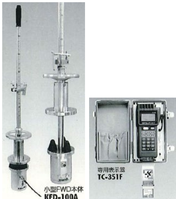
図-3.5.8 小型FWD試験装置の外観と仕様
