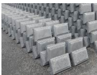
写真 4.2.9 SR セメントコンクリートによる積みブロックの実製造状況
