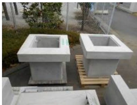
写真 4.2.7 設備機械基礎のモックアップ外観
