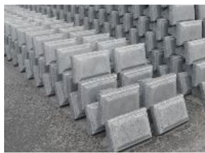
写真 4.2.4 SR セメントコンクリートによる積みブロックの実製造状況
