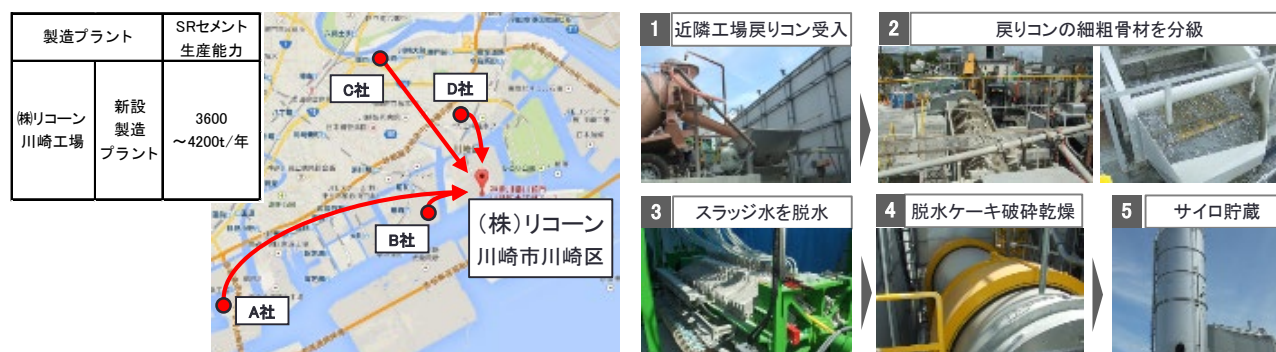
図 3.1.2 複数生コン工場の戻りコンを集積する新規製造プラント(リコーン：神奈川県川崎市)
