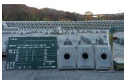
写真 4.2.9 SR セメントコンクリートによる積みブロックの実製造状況
