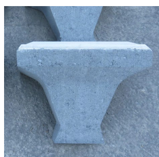
写真 4.2.9 SR セメントコンクリートによる積みブロックの実製造状況
