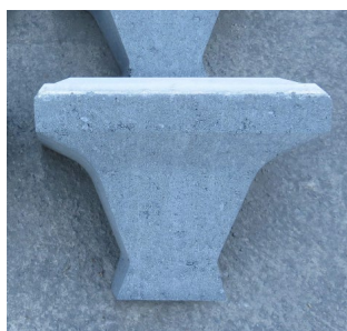
写真 4.2.4 SR セメントコンクリートによる積みブロックの実製造状況
