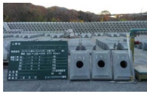
写真 4.2.4 SR セメントコンクリートによる積みブロックの実製造状況
