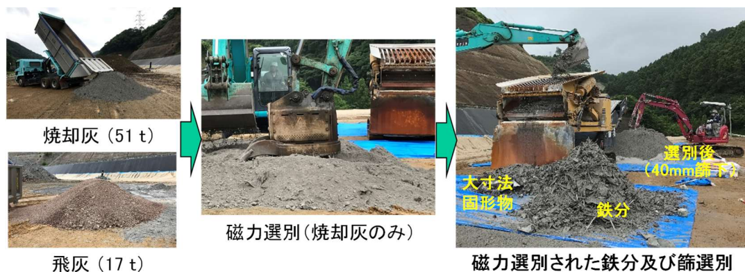
図 3.1.1 最終処分場で実施した一般廃棄物焼却残渣の粒度調整の実証試験
