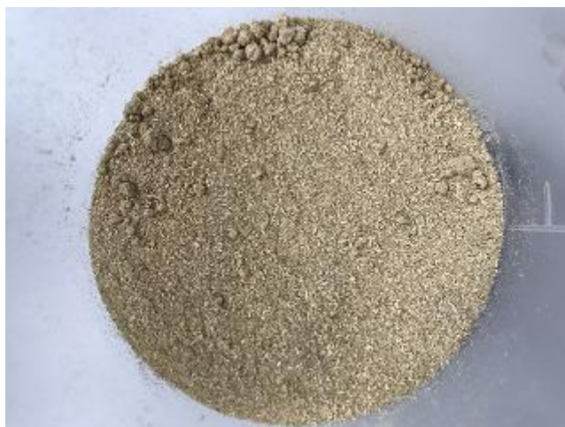
図 2.14 有機過酸化物を使用した容器リサイクル樹脂による木粉表面処理状態（ST-8）
