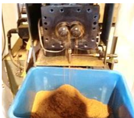
図 2.7 \phi 70\text{mm} 二軸押出機による表面処理能力テスト状況
