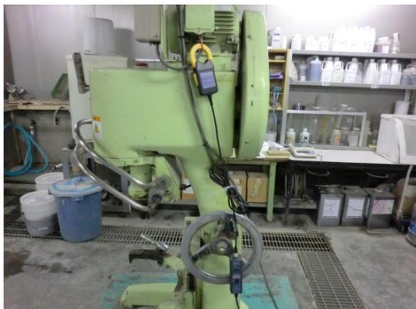
図 3-2-2 電流値計測器及びミキサー設置状況
