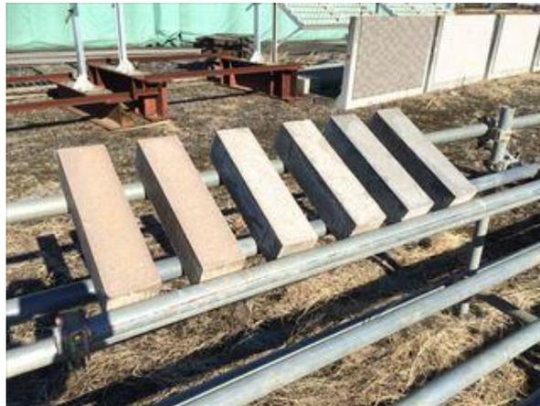
図 3-4-1 屋外曝露試験状況
