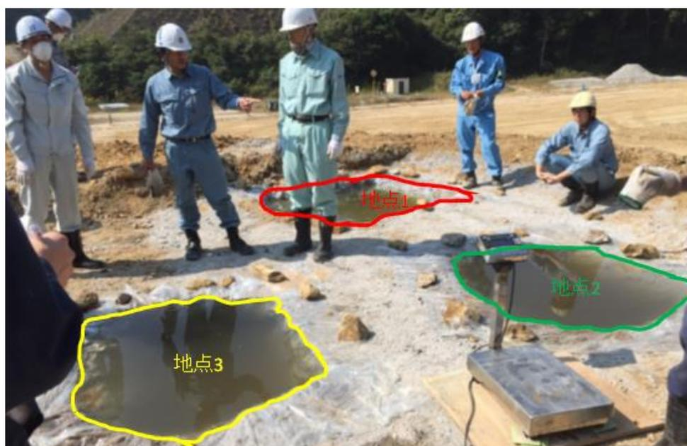
図 3-3-1 水置換法による従来式処分場の単位体積質量測定の様子
