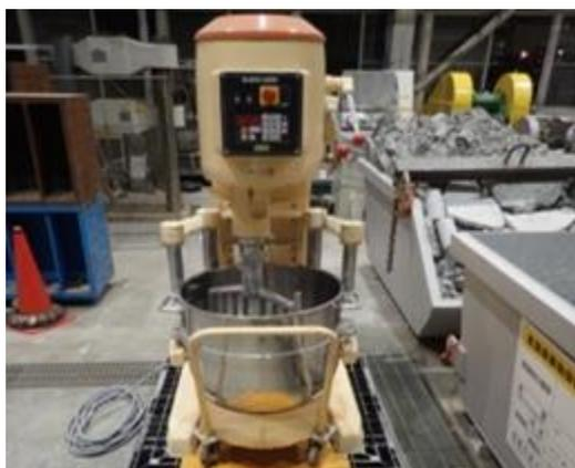
図 3-2-4 中型ホバート型ミキサー
