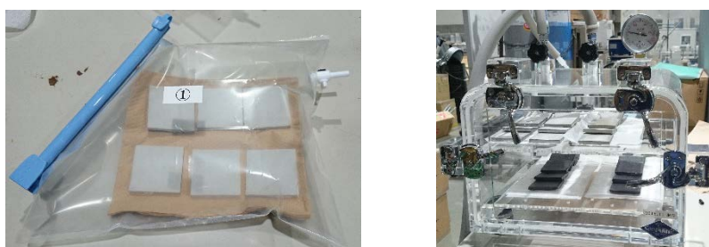
図 3 炭酸ガスを用いたセメント固化体の中性化の様子
