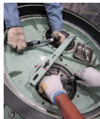
図 1 パイロットスケール遊星ボールミル装置
