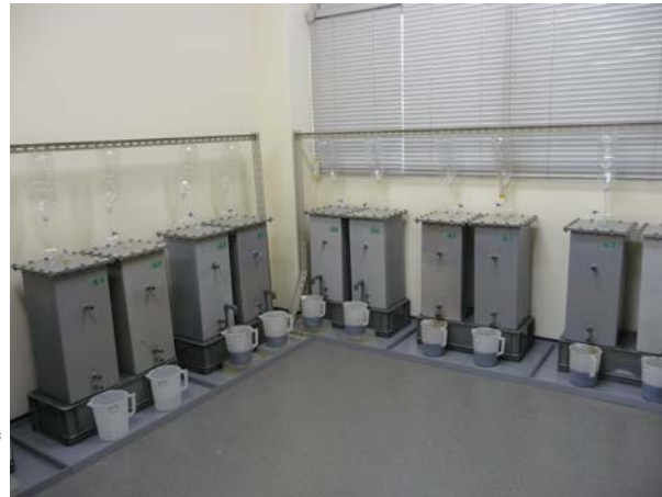
図5 水銀廃棄物の埋立槽図
