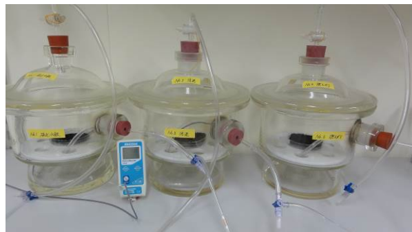
図6 実験試料からの気化水銀発生の基礎実験
