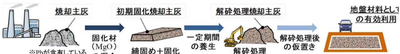
図 68 固化解砕処理の流れ
