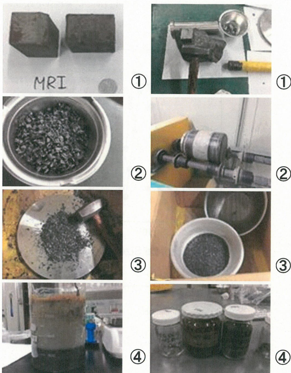
図1 MRI用磁石の粉碎過程
