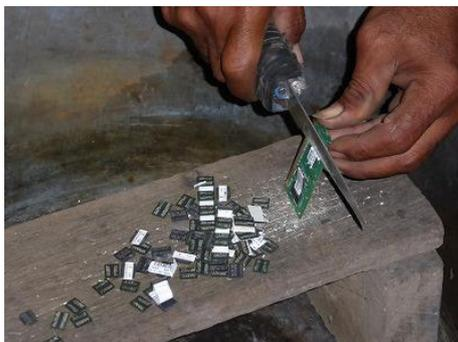
図 4.25 メモリ基板の IC チップと IC 選別作業
