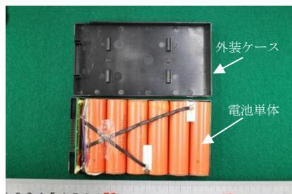
図 3.4 パソコン用リチウムイオン電池
