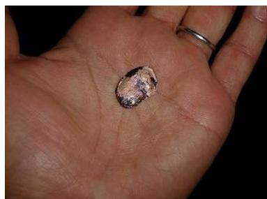
図 4.27 ハードディスク基板からの回収物 (Au が 6.8%と少ない)
