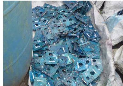
図 4.29 ハードディスク基板からのシアン処理残渣
