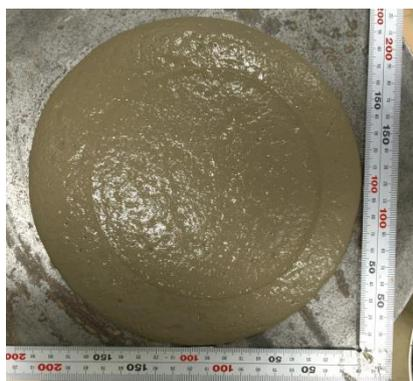
図 63 フロー試験の実施状況
