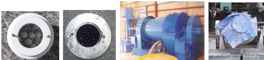
図 7 アスベスト分解用：小型磁製ミル (a)、小型ステンレスミル (b)、大型スチールミル (c)、モルタルミキサー (d)
