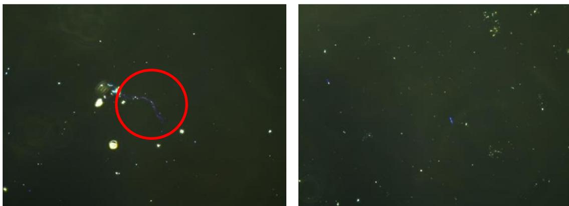
図 51 熊本地震後採取したスレートの分解処理前後の位相差顕微鏡・分散染色法分析。
