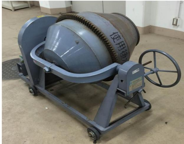
図 13 粒状化処理に用いたモルタルミキサー
