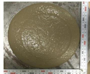
再資源化された造粒材料と流動性充填材料
