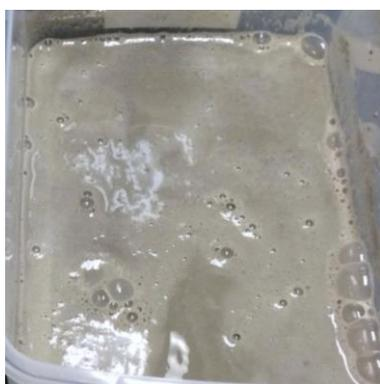
図 2 高含水比残渣の外観
