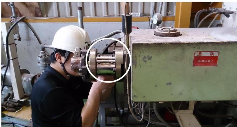
図 4-34 実際に熔融樹脂溜まりを設置したペレタイザー
