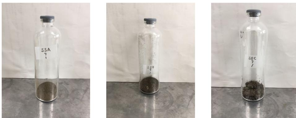
写真 3.6 バイアル瓶 (左から、分別土 A 種、分別土 B 種、分別土砂)
