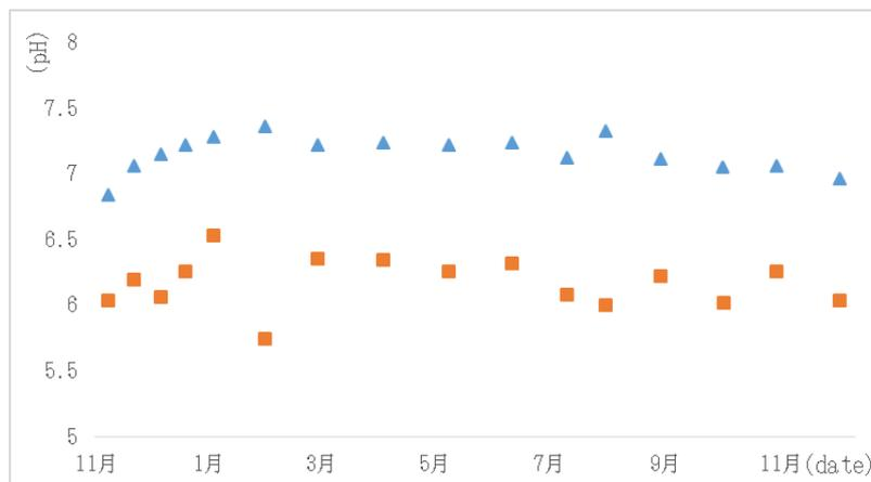
図 4.5.11 A槽、B槽のpHの経時変化 (■はA槽、▲はB槽)
