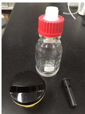
写真 3.3 酸素消費速度を求めるための試験器具
