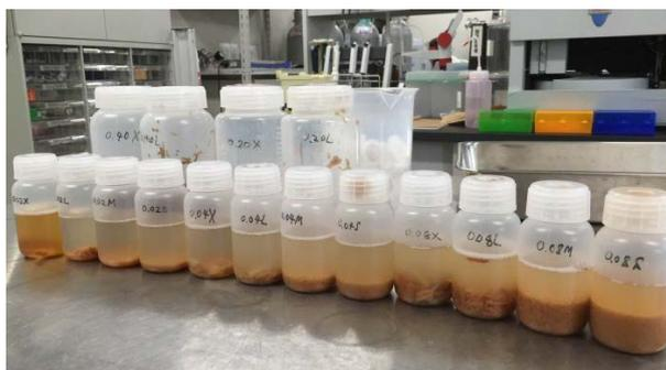
写真 3.2 木くずと純水投入後のポリ瓶の様子 (30 日経過後)
