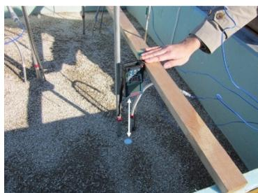
写真 3.8 沈下量の測定状況
