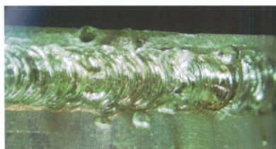
図 92 気密不良部の溶接部
