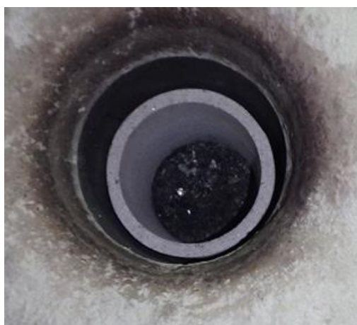
図 78 溶解炉へのるつぼの装填状況
