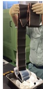
図 67 巻き戻しによる分離（装置化イメージ）
