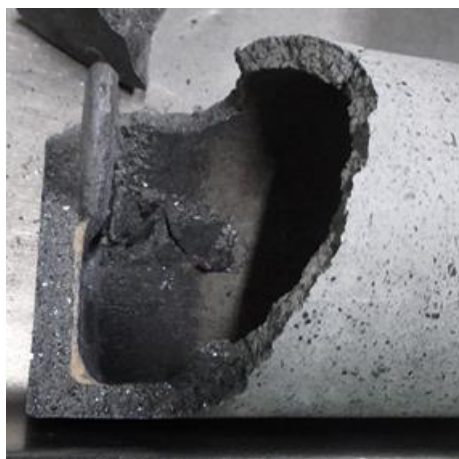
図 85 ルツボを破壊しメタルを取り出し
