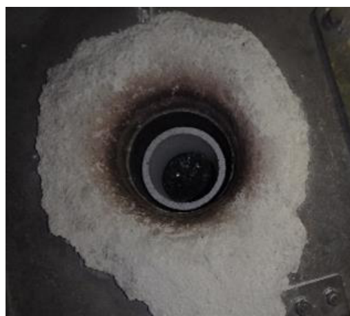
図 78 溶解炉へのるつぼの装填状況
