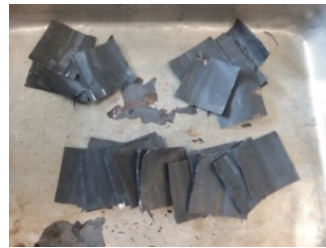
図 65 加熱脆化処理後の分離状況
