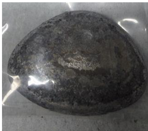
図 87 ルツボを破壊しメタルを取り出し
