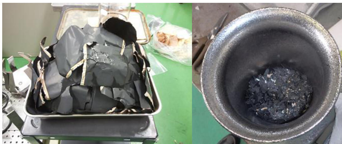
図 75 メタル回収に用いた正極、前処理（切断）
