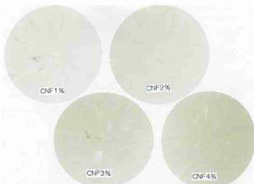
図 II-3-12 酸変性容リ樹脂①を相容化剤として添加したセルロースナノファイバー（CNF）と PP のコンポジットの熱プレス成形品の外観
