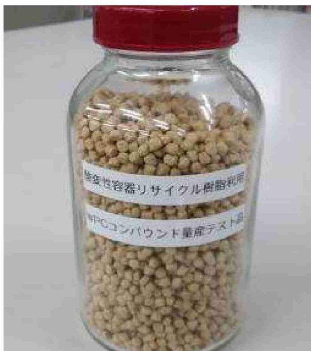
図 II-3-4 酸変性容リ樹脂を利用した WPC コンパウンド量産テスト品の外観
