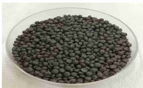
図 I-4 使用した容リ樹脂（(株) グリーンループ製 PP リッチペレット）の外観
