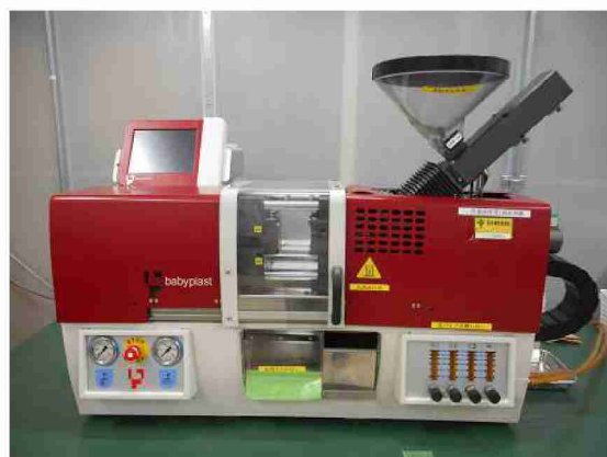
図 II-3-3 BabyPlast6/10 小型射出成型機と成型サンプルの外観
