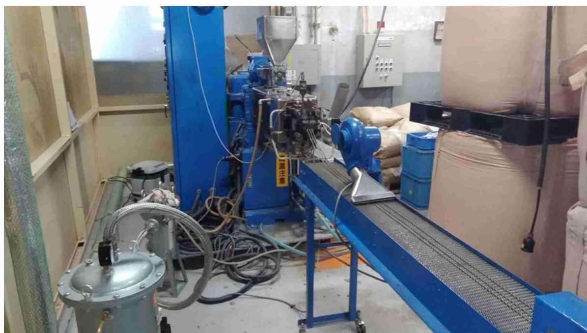
図 I-5 酸変性容り樹脂の量産試作に使用した異方向二軸押出機の外観
