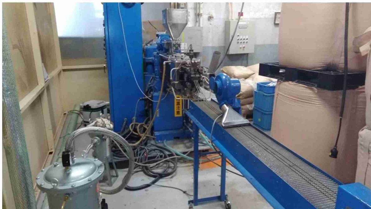
図 II-3-1 酸変性容リ樹脂の量産試作に使用した異方向二軸押出機の外観
