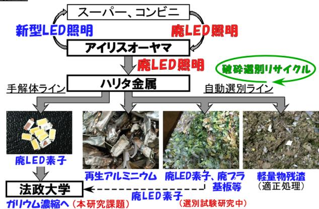
図2 直管型 LED 照明のリサイクルスキーム。
