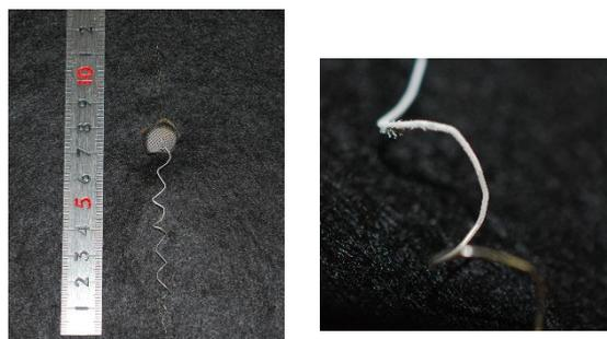
図 II-7 白金上へのガリウム化合物の回収状態.
