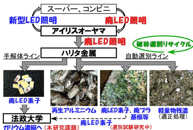
図 II-2 直管型 LED 照明のリサイクルスキーム。
