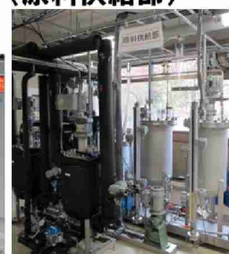
図Ⅱ-5 樹脂法による全自動運転のパイロットスケール製造装置の写真
