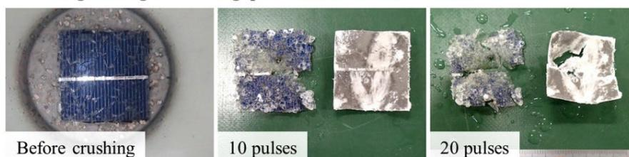
図3 多結晶タイプの第一段破碎で得られた産物（放電電圧の影響）
