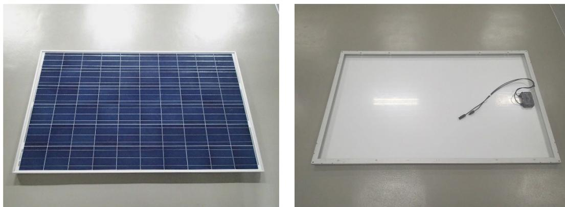
図1 本研究で対象とした多結晶タイプのパネルの全体図
