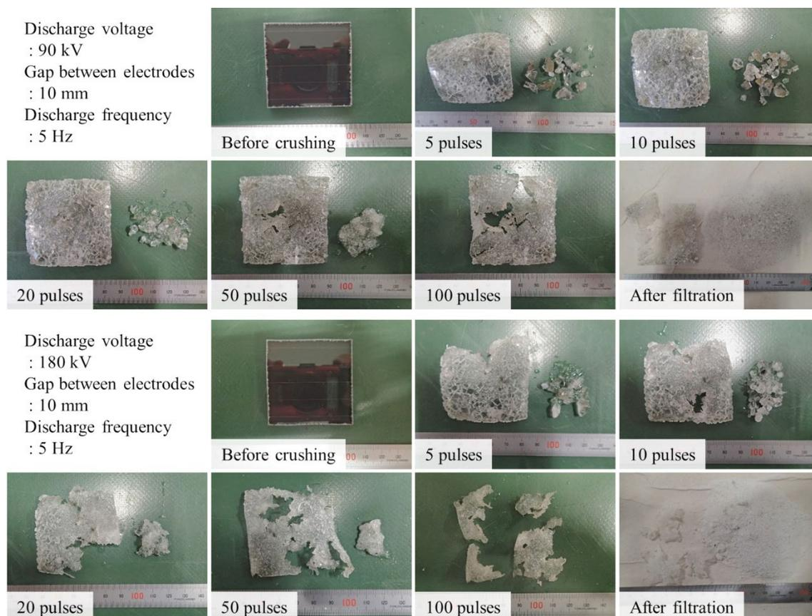
図 70 アモルファスタイプの高電圧パルス破碎実験で得られた産物（放電電圧の影響）
