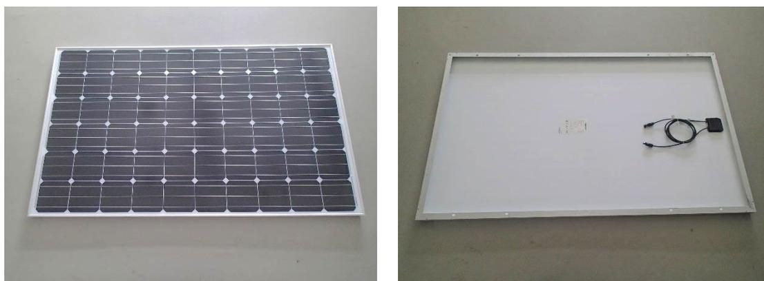
図 6 本研究で対象とした単結晶タイプのパネルの全体図
