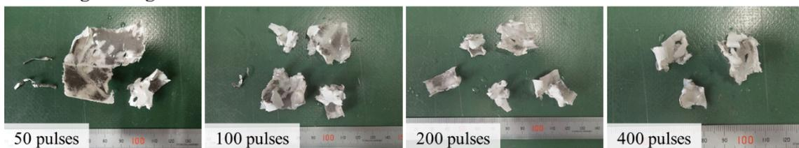
図 31 多結晶タイプのバックシート層の第二段破碎で得られた産物
