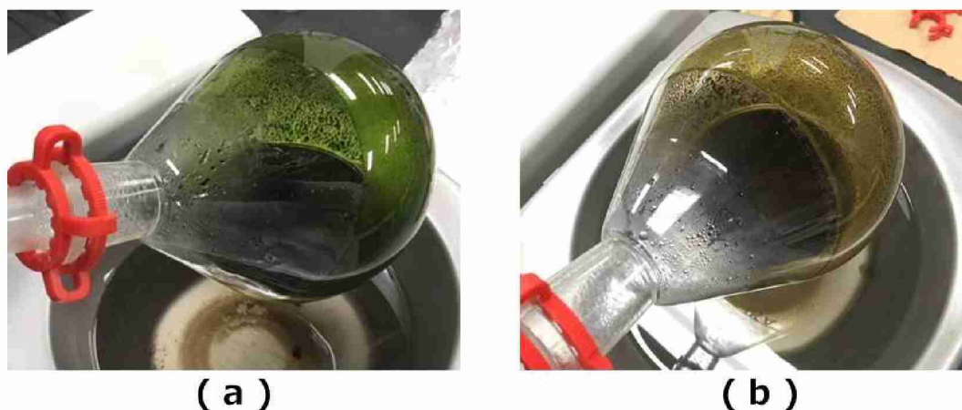
図 4.2.2.1 加熱・攪拌時の溶液：(a) メモ리카ード，(b) 携帯電話基板 Type-1
