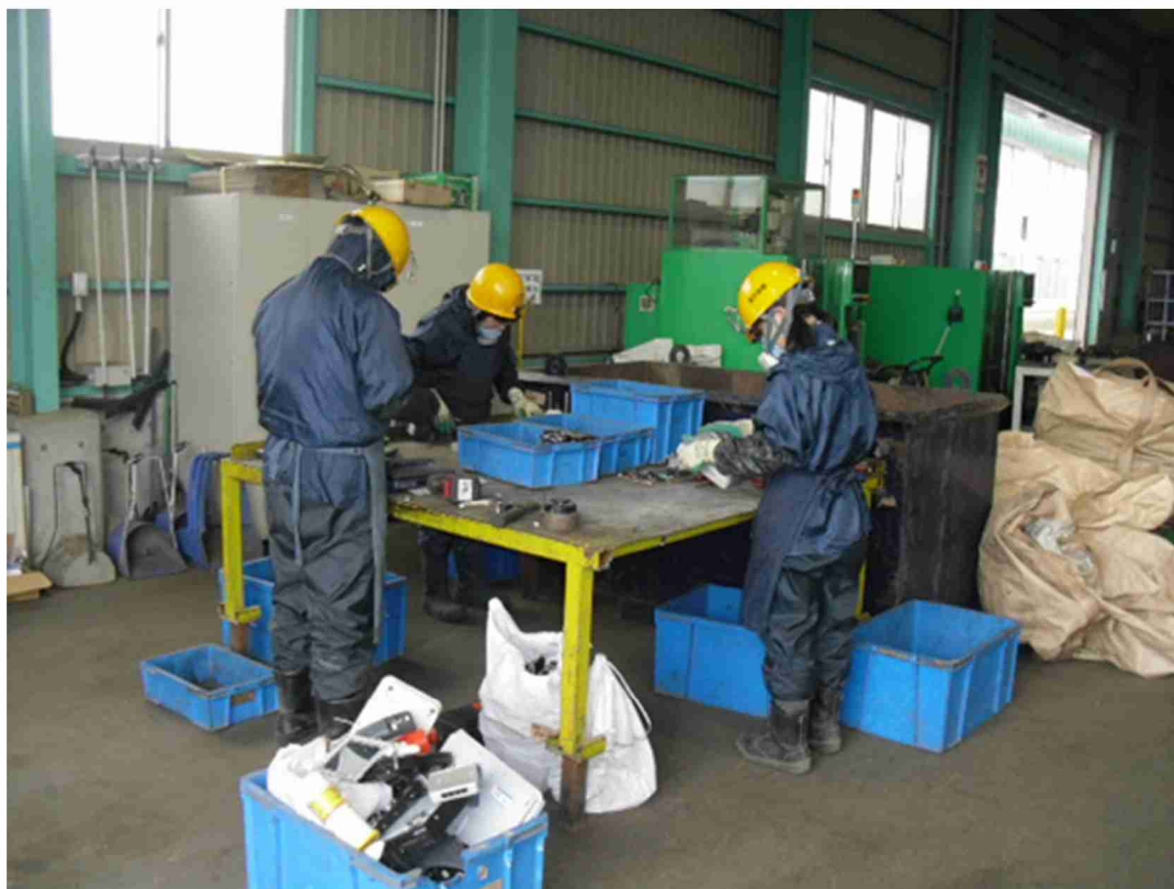
図 3.2 使用済み電気・電子機器の手解体風景
