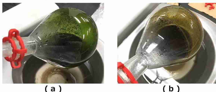
図 4.1.2 加熱・攪拌時の溶液（2.0 h 後）：(a) メモリカード、(b) 携帯電話基板
