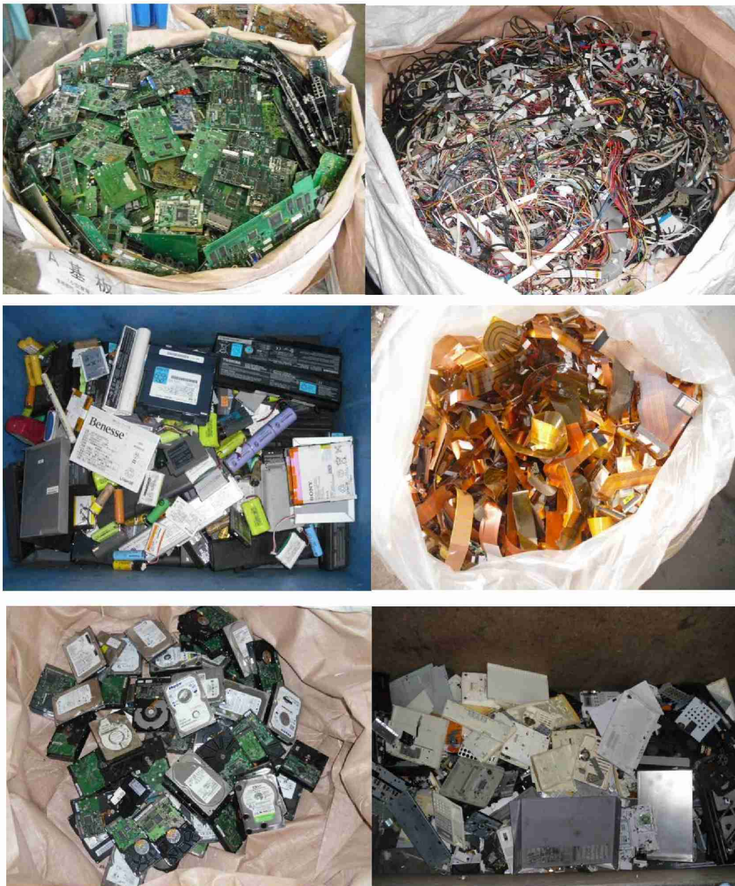
図 4.3.2 回収された各部位の写真（上左：基板、上右：ハーネス、中左：電池類、中右：フレキ、下左：ハードディスク、下右：ミックスプラ等）
