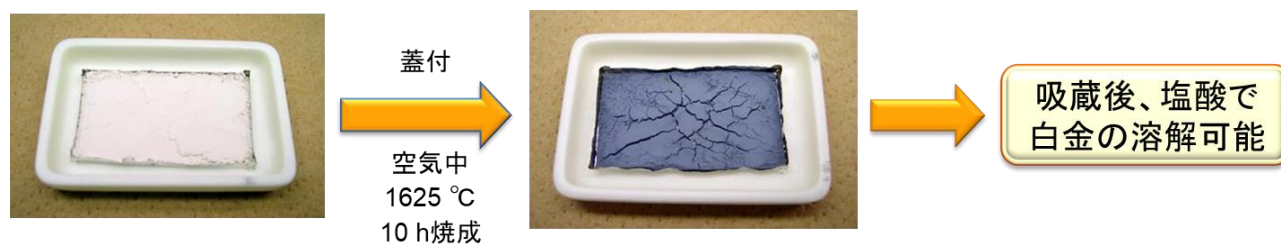
図 1-5 LSBS 粉末の Pt 吸蔵、及び LSBS に吸蔵された Pt の塩酸への溶解
