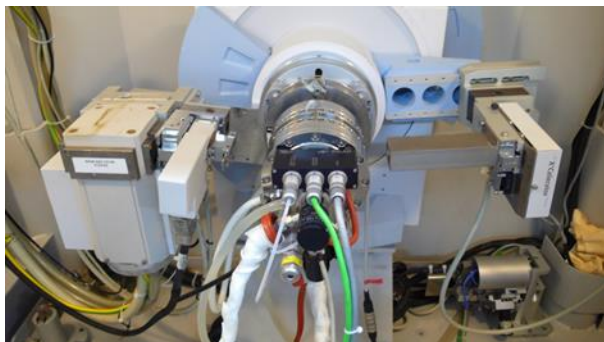
図 3-3 X線回折装置（ディフラクトメータ（集中法光学系、半導体検出器付）及び試料加熱装置）
