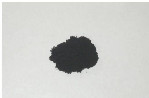
図7 燃料電池用電極触媒 (田中貴金属工業株式会社製 TEC61E54、C:Pt:Ru = 46.7:30.0:23.3 mass%)
