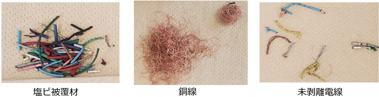
図16 湿式剥離試験後の試料②の写真
