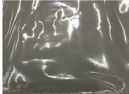
図19 回収塩ビ被覆材を添加したオープンロール練り試験条件およびシート写真
