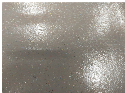
図19 回収塩ビ被覆材を添加したオープンロール練り試験条件およびシート写真
