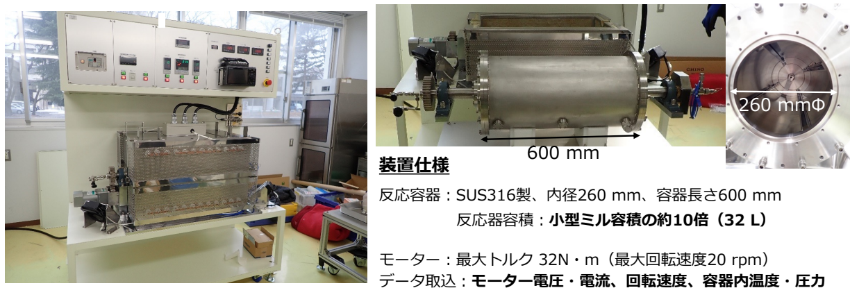
図12 ベンチスケールミル外観および内観写真、および装置仕様
