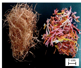
図0.1 n -Butyl acetate膨潤後の乾式ボールミル剥離にて得られた試料写真および回収銅線の長さ分布
