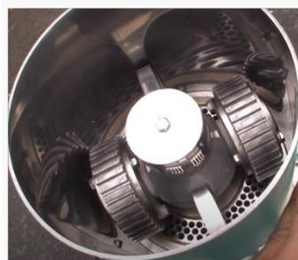
図-1.4 ダルトン社製押出造粒機の外観および試料投入部写真
