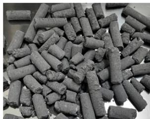
図-1.24 押出造粒機を用いた無害化ドロスの造粒ペレット外観
