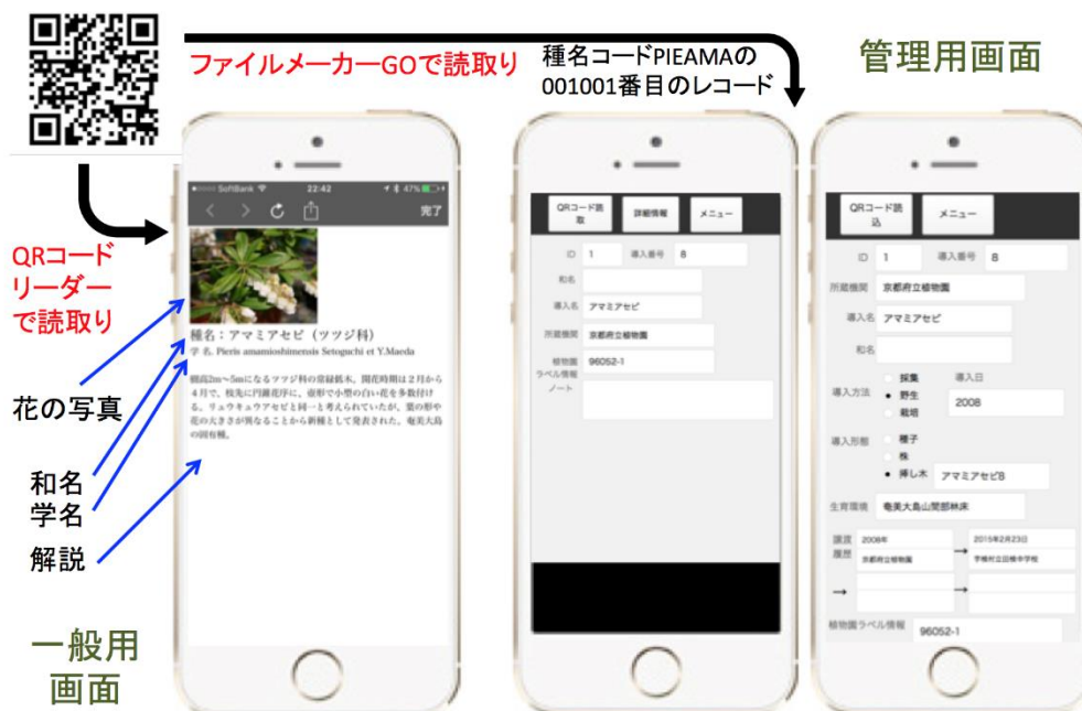
図(3) -8. QRコードリーダーで読み込んだ時に一般用と管理用画面を表示させるシステムの実装
