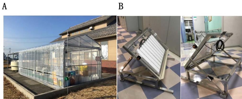
図(4)-1. (A) 滋賀県立大学湖沼実験施設敷地内に設置したビニールハウス、(B) LED付き10-Lフラットパネル型藻類培養リアクター
