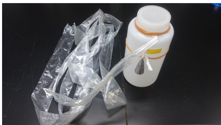
図(6)－3 122箇所の採水調査を迅速に実施するために考案したビニール紐付きの採水ボトル。
