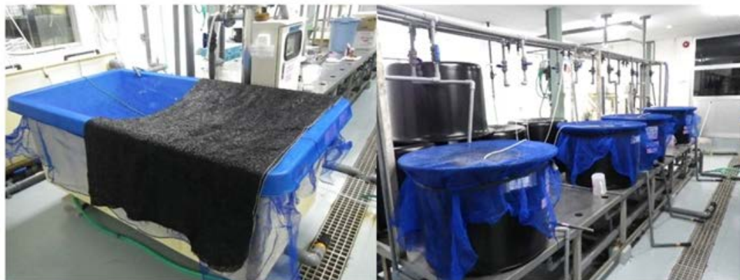
図3.4.2 ブルーギルの飼育装置（左：1,000L容角形水槽、右：200L容円形水槽）
