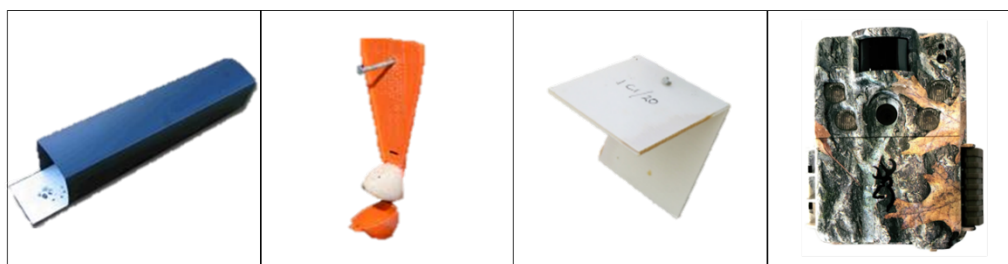
図5.4.2 マンダースモニタリング試験において使用したモニタリングツール (左から、足跡トラップ、噛み痕トラップ (Wax Tag)、噛み痕トラップ (Chew Card)、 センサーカメラ)
