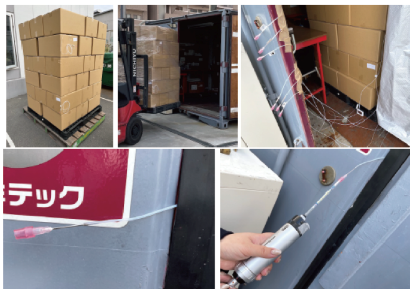
図2-3 本研究で開発したコンテナの扉を閉じたまま，外部から積載貨物内のガス濃度を測定する手法の概要
