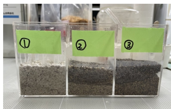
図 1－3 浸透試験の状況
