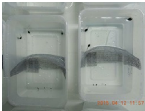
図 1 1 成長抑制フェロモンを検証する実験装置。真ん中に網で区切りがしてあり、オタマジャクシ大とオタマジャクシ小が物理的に接触できないようになっている
