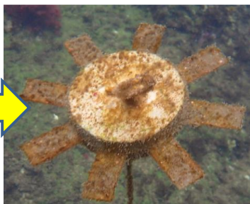
図3 プレート設置の様子 左図は設置前のプレートを示す。右図は72日間係留したプレートを示す。
