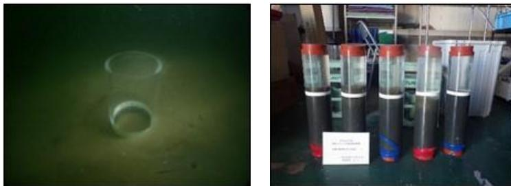
図(5)-7 未攪乱堆積物コアの採取状況
