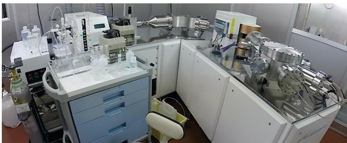
図(2)-3 水銀同位体分析に使用した多重検出器型誘導結合プラズマ質量分析装置
