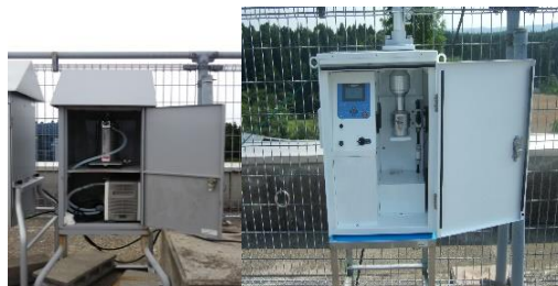
図(4)-4 アンダーセンサンプラーAN-200(左)及びPM 2.5 サンプラーLV-250R(右)
