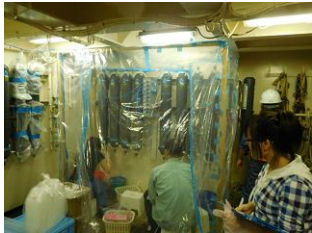
クリーン採水法での 海水試料の分取
