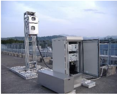
図(4)-1 Tekran社製大気中形態別水銀自動測定装置
