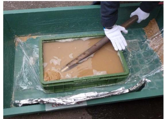
写真(2)-7 汚染土壌のLLMIP試験実施状況
