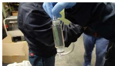
②回収したスナップサンプラー内の試料瓶
