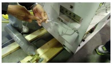
(g) GC-PID分析ガス試料採取
