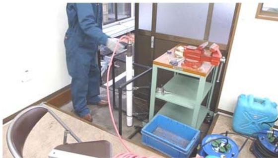
写真(2)-6 汚染水のMIP試験実施状況
