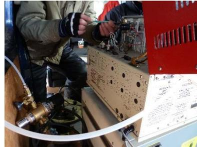
(e) PID測定器の排出ガス採取
