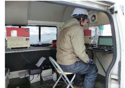
(f) ガス試料のGC-PID分析
