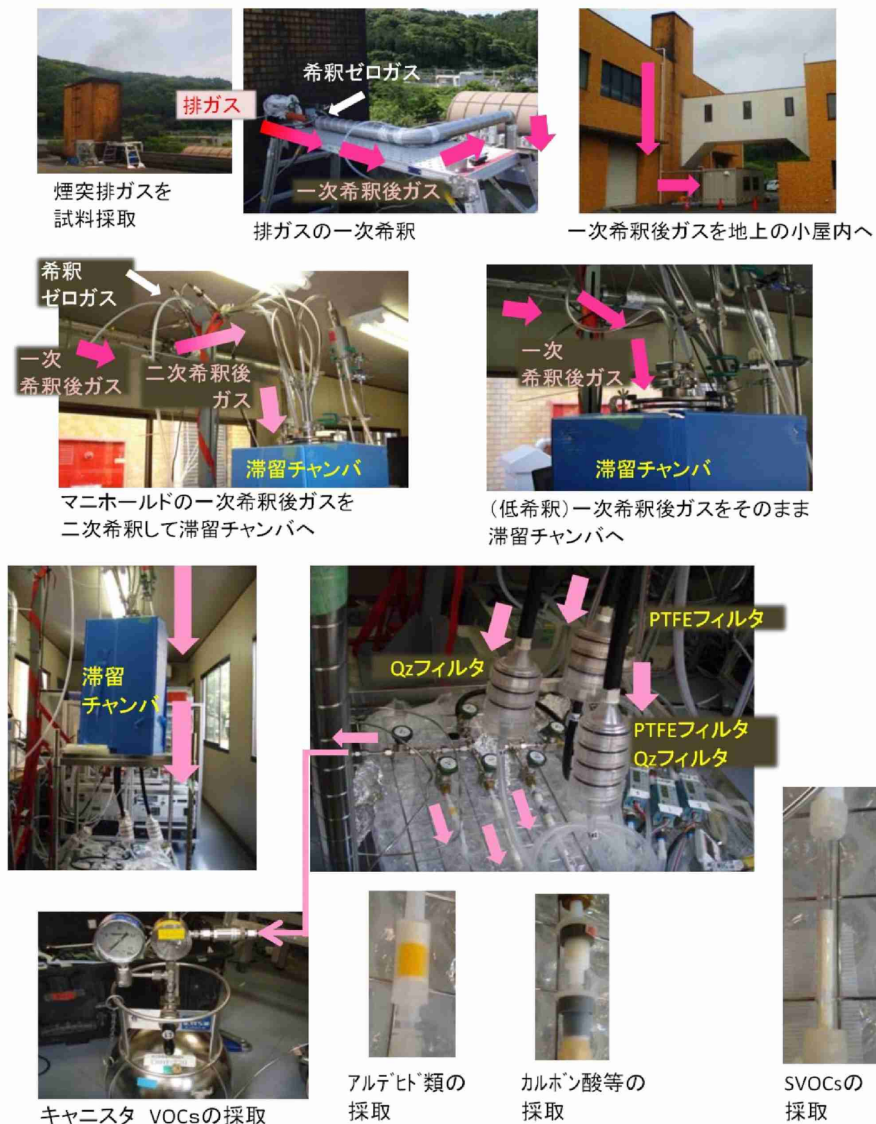
図(2)-18 浄化槽汚泥乾燥焼却施設における凝縮性ダストおよびガス成分の採取
