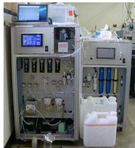
図(1)-2 都環研6階観測室でのアンモニア計（左）と標準ガス希釈装置（右）
