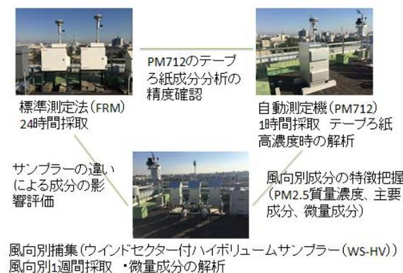
図(2)-1 PM<sub>2.5</sub>採取装置と研究概要
