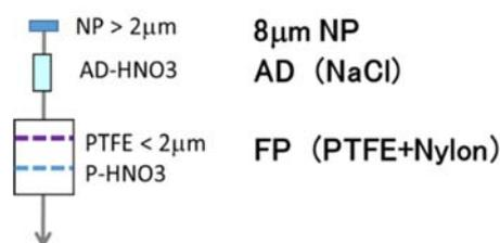
図(1)-3 デニューダー・多段フィルタ法によるHNO<sub>3</sub>と粒径別（粗大・微小粒子）サンプリング
